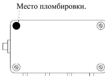
Рисунок 3 — Схема пломбировки соединительной коробки от несанкционированного доступа
