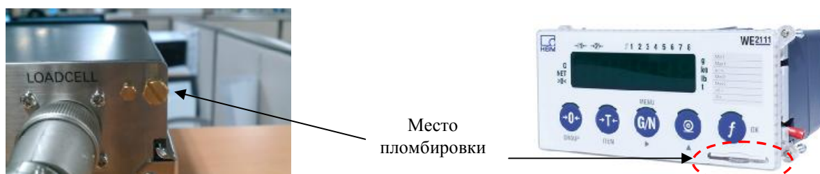
Рисунок 7 — Схема пломбировки приборов весоизмерительных CI-600D (свинцовый пломбой), WE2111 (с помощью разрушаемой наклейки)
